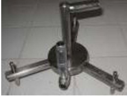
Yumurta ak ve sarı yüksekliği ölçümü (üç ayaklı mikrometre)
